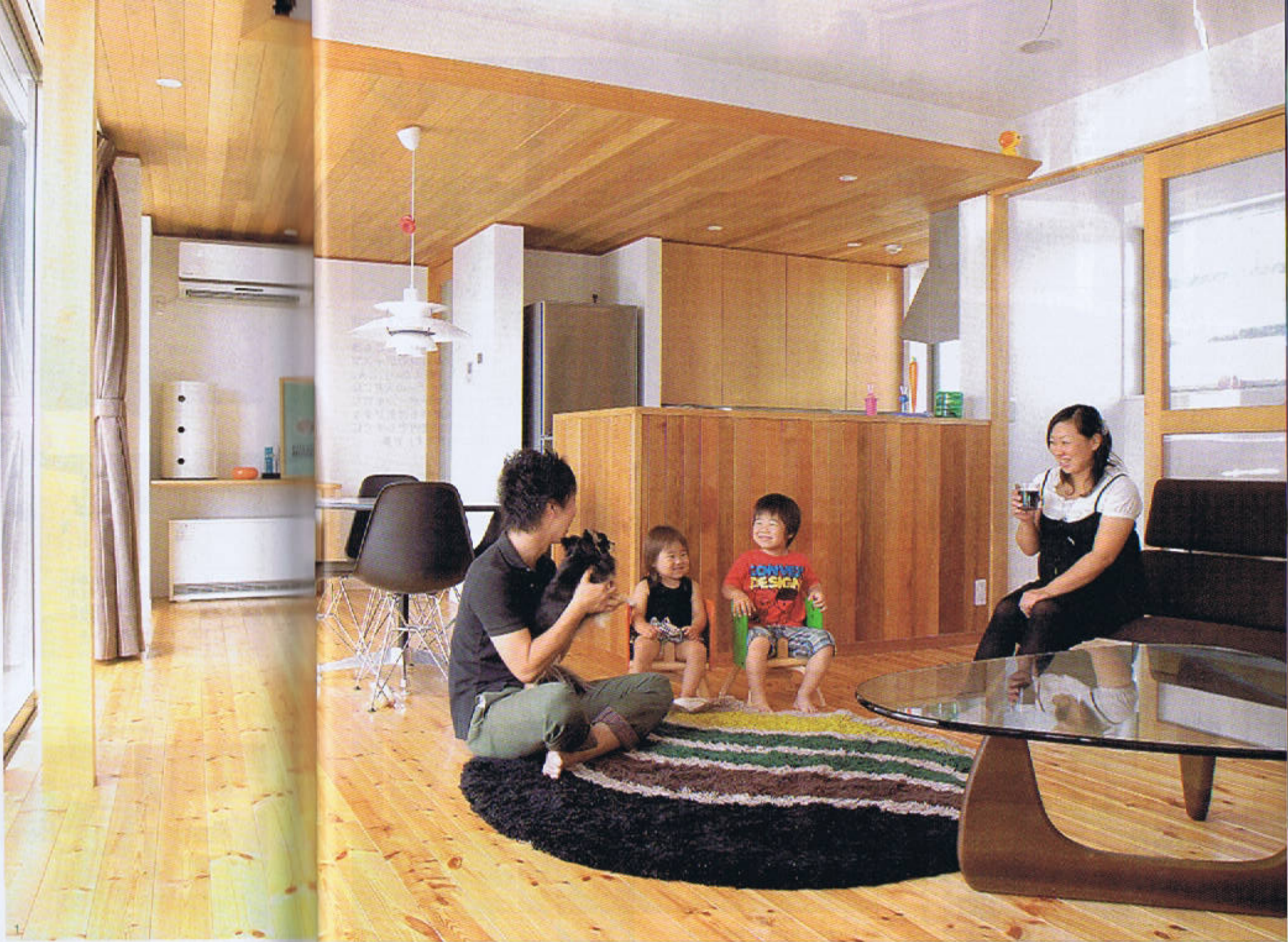
1.断熱材を敷き詰めた床の上には、足触りのよい天然パインのむく材を張り、自然塗料を塗って仕上げた。天井の一部やキッチンカウンターにレッドシダーを張り、ナチュラル感を高めて。壁際のカウンター下に設置したのが蓄熱暖房。冬は遠赤外線ですばやく暖めてくれる
