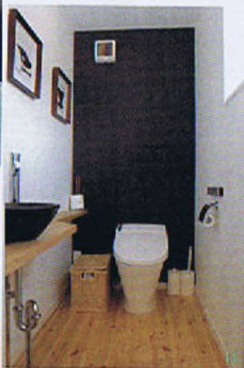
11. 「トイレも広く」と、スペースをゆとり確保したトイレは、壁の一面に黒いクロスをはり、絵を掛けたりして、おしゃれな空間に。黒い壁の左上にあるのが、24時間換気システムの排気口。住まいの空気を循環させることで、均一な温度環境をつくる。12. 浴室は、断熱性のあるシステムバスを採用。トイレ同様、白と黒でシックに
